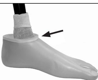
Pašiauškite viršutinį pėdos protezo apvalkalo paviršių. Priklijuokite 8mm „Pelite“ sandūrą prie pėdos protezo apvalkalo ir suteikite reikiamą formą. Naudokite „Evostik 528“ (926213) arba lygiaverčius klijus.
