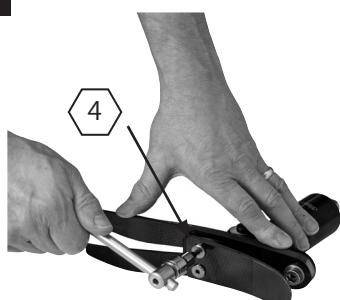
4 卸下前掌弹片螺丝，更换前掌弹片。重新装配好后，涂抹乐泰 243 (926012) 防松胶并拧紧至 35 牛米。确保前掌弹片位于龙骨的中心位置。
