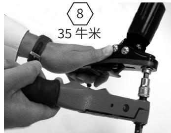
5 用后跟弹片替换件重新装配。涂抹 Loctite 243 (926012) 防松胶并拧紧至 15 牛米。
