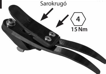
Szerelje a sarokrugót a tartóra, használjon Loctite 243 csavarrögítőt (926012), és húzza meg 15 Nm nyomatékra.
