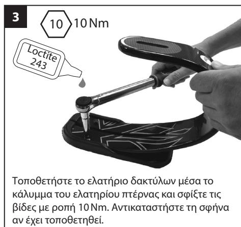
Τοποθετήστε το ελατήριο δακτύλων μέσα το κάλυμμα του ελατηρίου πτέρνας και σφίξτε τις βίδες με ροπή 10 Nm. Αντικαταστήστε τη σφήνα αν έχει τοποθετηθεί.
