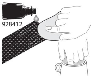
Temeljito očistite kraj cijevi od karbonskih vlakana i unutrašnjost kućišta stezaljke. Upotrijebite prikladno sredstvo za čišćenje na bazi otapala poput acetona (928412). Ostavite da se osuši. NEMOJTE DODIRIVATI OČIŠĆENA PODRUČJA.
