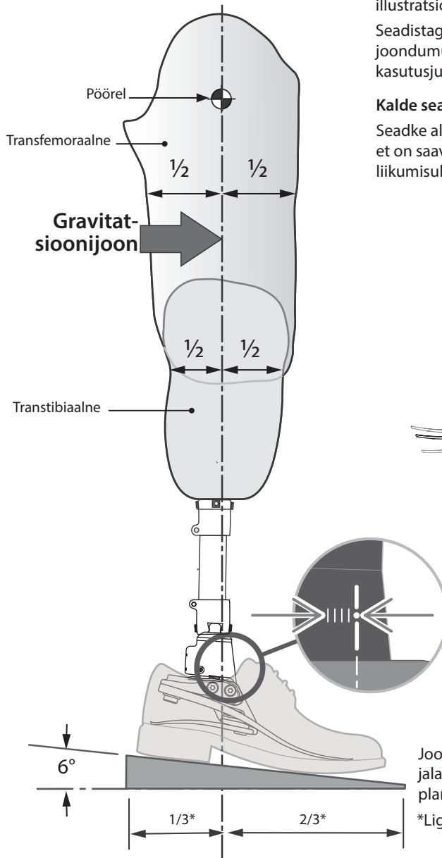
Kasutage vajaduse korral nihutamise ja kallutamise seadiseid, et gravitatsioonijoon jäeks pöördetelgede vahele, nagu näidatud illustratsioonil.
