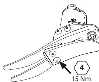
Zmontujte ich s náhradou päťovou pružinou. Použite Loctite 243 (926012) a doťahovací moment 15 Nm.
