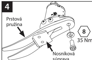
Odskrutkujte skrutku prstovej pružiny, vyberte prsty. Pri skladaní použite Loctite 243 (926012) a doťahovací moment 35 Nm. Dbajte na to, aby bola prstová pružina v strede nosníka.
