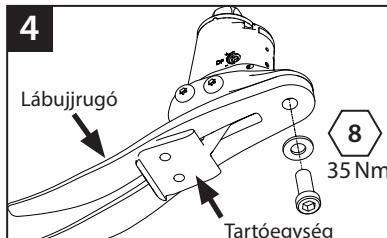
Vegye ki a lábujjrugó csavarját, cserélje ki a lábujjat. Az újból összeszerelésnél használjon Loctite 243 csavarrögzítőt (926012), és húzza meg 35 Nm nyomatéka. Ügyeljen arra, hogy a lábujjrugó a tartó közepén helyezkedjen el.
