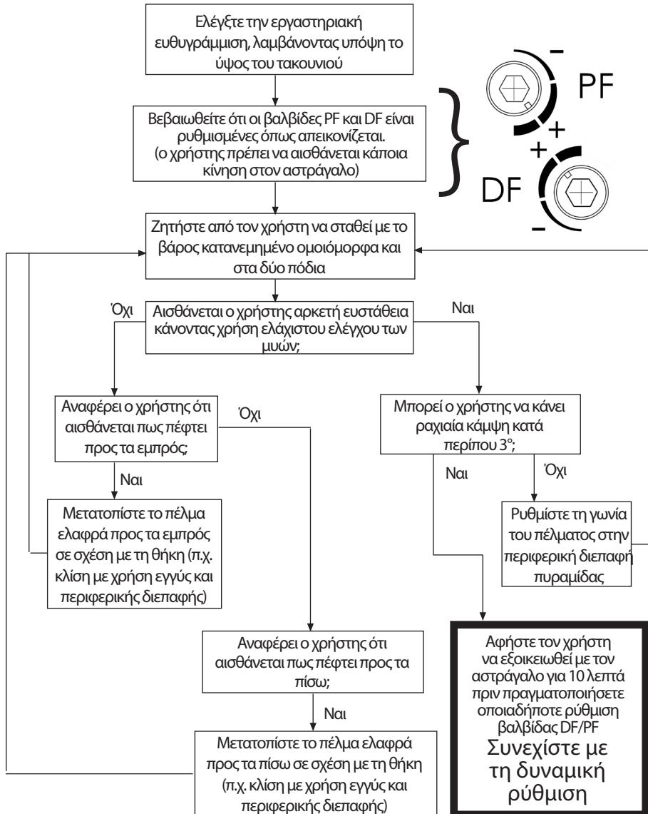
Χρησιμοποιήστε τη μετατόπιση για στατική ευθυγράμμιση και όρθια στάση.
