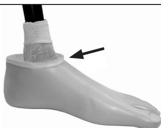
Raspe a superfície superior do revestimento cosmético do pé. Una uma interface Pelite de 8 mm ao revestimento cosmético do pé e molde para a forma desejada. Utilize Evostik 528 (926213) ou equivalente.
