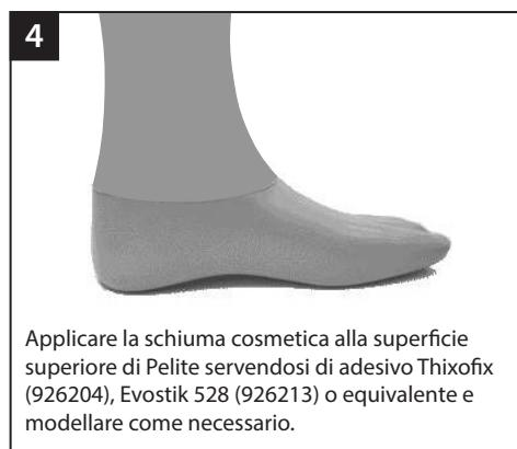
Applicare la schiuma cosmetica alla superficie superiore di Pelite servendosi di adesivo Thixofix (926204), Evostik 528 (926213) o equivalente e modellare come necessario.
