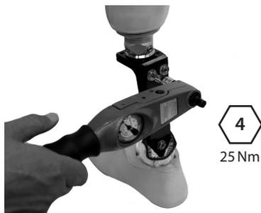
Applicare Loctite (243) e serrare (25 Nm) i bulloni dell'alloggiamento superiore. Collegare e allineare l'invasatura.
