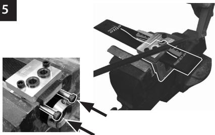
Rimuovere l'invasatura, posizionare il morsetto nella morsa e tagliare la lamina alla lunghezza necessaria. Installare le viti di spallamento per evitare danni ai componenti
