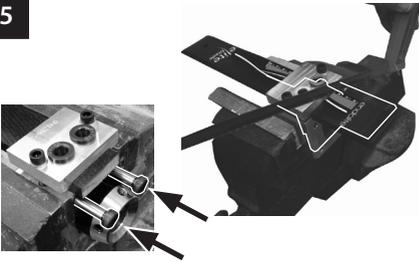
Entfernen Sie den Schaft, legen Sie die Einbauklemme in die Spannvorrichtung und schneiden Sie die Blade auf die passende Länge zu. Bringen Sie Schulterschrauben an, um eine Beschädigung der Komponenten zu verhindern.
