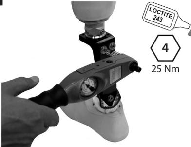
Schneiden Sie den Pylon mit dem zuvor gezeigten Verfahren zu, bevor er am oberen Gehäuse angebracht wird. Tragen Sie Loctite (243) auf, und ziehen Sie die Schrauben an (25 Nm). Bringen Sie die Kosmese bei Bedarf wieder an.
