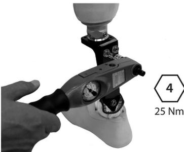
Tragen Sie Loctite (243) auf, und ziehen Sie die Schrauben des oberen Gehäuses an (25 Nm). Bringen Sie den Schaft an und richten ihn aus.
