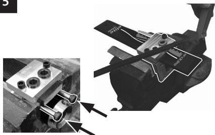
Retirar el encaje, colocar la abrazadera de montaje en el tornillo de banco, y cortar la prótesis a la longitud deseada. Poner tornillos de asiento para evitar daños a los componentes
