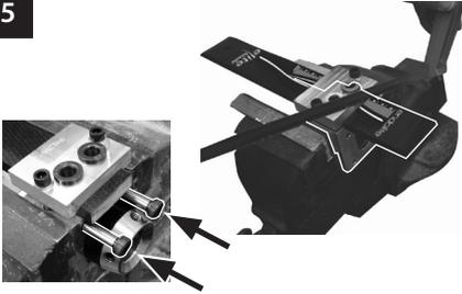
Verwijder de koker, plaats de montageklem in het hulpmiddel en snij het blad af op de juiste lengte. Breng de schouerschroeven aan om schade aan componenten te voorkomen
