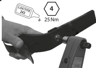
Acoplar el pilón a la base de soporte. Aplicar Loctite (243) y apretar el perno (25 Nm).
