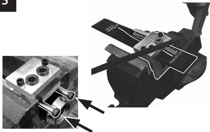
Sejměte objímku, upevněte upínací svorku do svěráku a seřízněte lištu na délku. Namontujte osazený šroub, aby nedošlo k poškození součástí.
