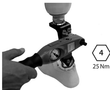
Aplicar Loctite (243) y apretar los pernos de la carcasa superior (25 Nm). Acoplar y alinear el encaje.
