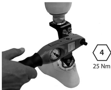
Aplique Loctite (243) e aperte os parafusos da estrutura superior (25 Nm). Coloque e alinhe o encaixe.
