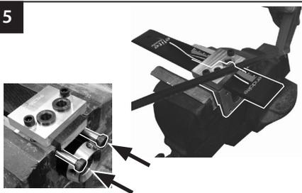
Retire o encaixe, coloque a braçadeira de fixação no torno e corte a lâmina no comprimento adequado. Coloque parafusos de cabeça cilíndrica para evitar danos nos componentes.
