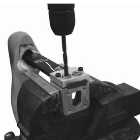
Praticare con il trapano due fori di diametro di 8,1 mm attraverso le apposite boccole.
