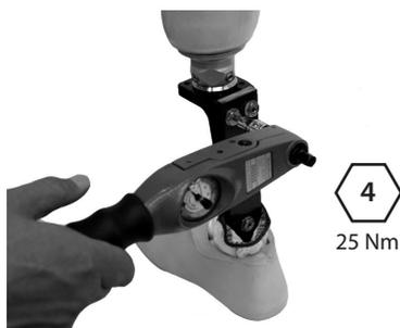
Appliquez du Loctite (243) et serrez (25 Nm) les boulons du boîtier supérieur. Fixez et alignez l'emboîture.
