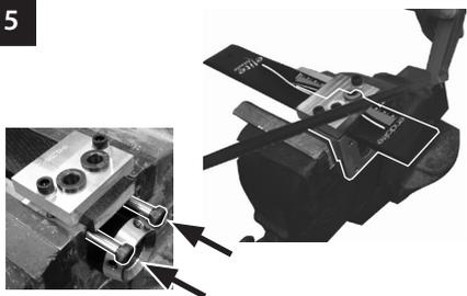
Retirez l'emboîture, placez la pince de pose dans l'étau et coupez la lame à la longueur voulue. Utilisez des vis à tête cylindrique longues pour éviter d'endommager les composants.
