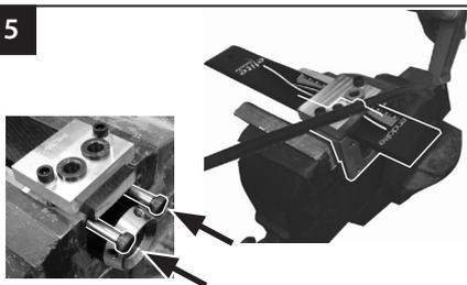
Zdemontować lej, umieścić zacisk mocujący w imadle i przyciąć listwę do odpowiedniej długości. Zamontować śruby z niepełnym gwintem, aby zapobiec uszkodzeniu komponentów.
