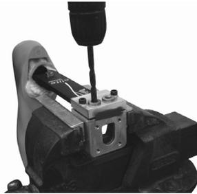
Boor twee gaten met een diameter van 8,1 mm door de booropeningen.
