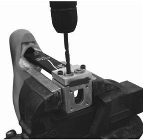
Bohren Sie zwei Löcher mit einem Durchmesser von 8,1 mm durch Bohrbuchsen.
