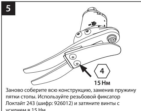
Заново соберите всю конструкцию, заменив пружину пятки стопы. Используйте резьбовой фиксатор Локтайт 243 (шифр: 926012) и затяните винты с усилием в 15 Нм.
