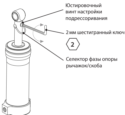
Юстировочный винт настройки подрессоривания
