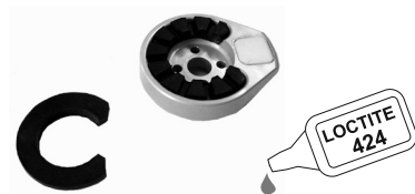
Obr. 2. Namontovaný střední tlumič
