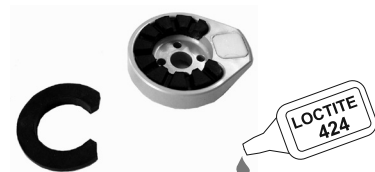
Image 1 Dôme retiré, prêt pour l'installation du tampon Image 2 Tampon moyen installé
