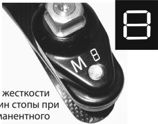
Для указания жесткости набора пружин стопы при помощи перманентного маркера черного цвета закрасьте на несущей стопы соответствующие сегменты маркировки так, как показано на рисунке.
