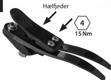
Montér hælfjederen på bæreenheden ved brug af Loctite 243 (926012) og et moment på 15 Nm.
