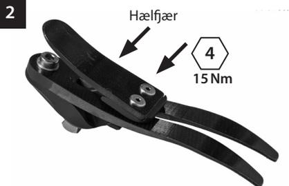
Monter hælfjæren på bæreren, bruk Loctite 243 (926012) og dreiemoment til 15 Nm.
