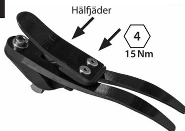
Montera hälfjädersn på bäraren. Använd Loctite 243 (926012) och ett vridmoment på 15 Nm.
