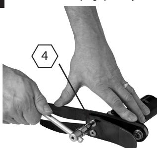
**4** Odvijte vijak opruge palca, zamijenite oprugu palca.
