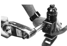
Fixe a lâmina anterior ao suporte aplicando Loctite 243 (926012) nos parafusos.
