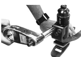
Przymocować sprężynę palców do zespołu nośnego i zabezpieczyć gwinty śrub klejem Loctite 243 (926012).
