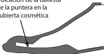
Asegúrese de que la ballesta de la puntera se encaja correctamente en la ranura de ubicación de la cubierta cosmética.
