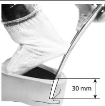
A calçadeira deve ser posicionada cerca de 30 mm abaixo da superfície superior do revestimento cosmético do pé para garantir um encaixe total da lâmina posterior.
