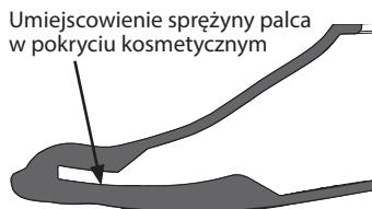
Należy upewnić się, że sprężyna palca jest prawidłowo zamocowana w przeznaczonym na nią rozcięciu w pokryciu kosmetycznym.
