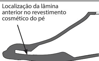
Certifique-se de que a lâmina anterior fica bem colocada na ranhura existente no revestimento cosmético do pé.
