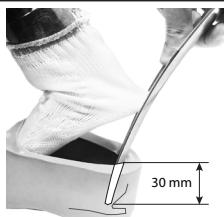
Il calzante dovrebbe essere posizionato circa 30 mm sotto la superficie superiore del rivestimento per garantire il corretto inserimento della lamina del tallone.
