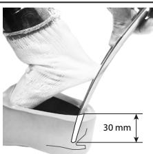
Roh boty by měl být umístěn cca 30 mm pod horním povrchem skořepiny chodidla, aby bylo zajištěno plné uchycení patní pružiny.
