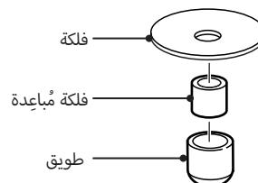
يُوفر هذا الجهاز طريقة لتركيب تجويف مصحّح في ركبة رباعية القضبان مخصصة للأطفال من Blatchford، مما يسمح بمحاذاة الأطراف الصناعية المخصصة لتناسب المستخدم. عند إحكام ربط مسمار المحاذاة اللولي (باستخدام لاصق لوكتait) وفقاً لإعداد عزم الدوران الموضح في قسم التركيب، يُوفر هذا الجهاز طريقة آمنة للتوصيل بين الركبة والتجويف.
