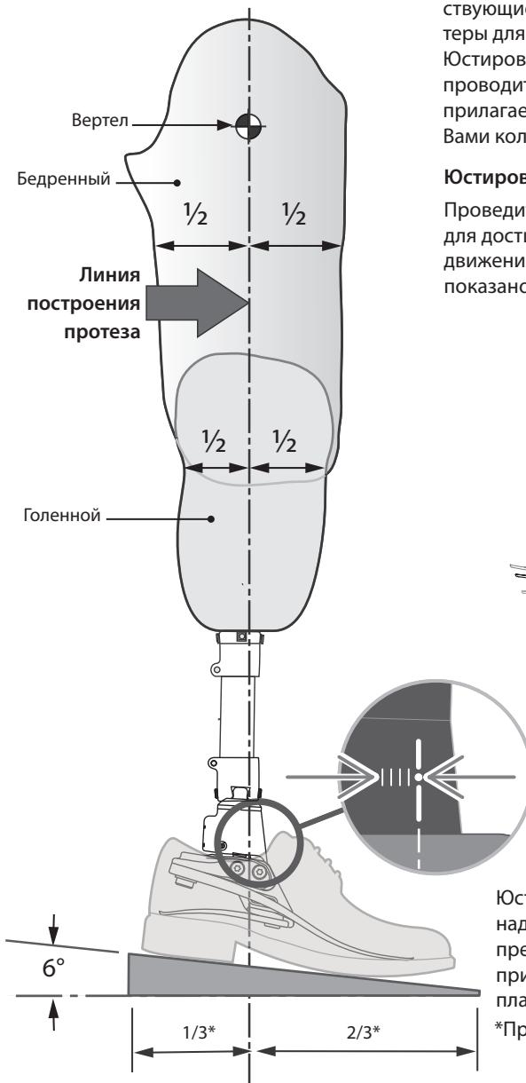
Необходимо строго придерживаться вертикальной осевой линии построения протеза, при необходимости используйте соответствующие сдвиговые адаптеры и/или адAPTERЫ для обеспечения требуемого наклона. Юстировка бедренной системы должна проводиться согласно инструкциям, прилагаемых к конкретному используемому Вами коленному модулю.
