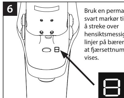
Bruk en permanent svart markør til å streke over hensiktsmessige linjer på bæreren slik at fjærsett nummeret vises.
