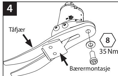
Fjern tåfjærskruen, bytt ut tå. Bruk Loctite 243 (926012) og dreiemoment til 35 Nm når du setter det sammen igjen. Sørg for at tåfjeren er midt på bæreren.
