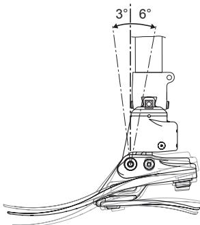
Юстировка проводится с надетой на стопу пользователя предпочтаемой обувью при полностью выбранной плантарфлексии.
