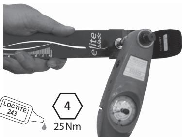
Priklučite stupni dio na nosač pete. Nanesite Loctite (243) i zategnite vijak (25 Nm).
