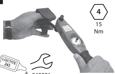
Osadte novú päťovú pružinu, naneste Loctite (243) a dotiahnite skrutky (15 Nm). Použite násadu na očkový kľúč 940081)
