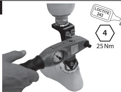
Odrežite stupni dio prethodno prikazanim načinom prije nego što postavite gornje kućište. Nanesite Loctite (243) i zategnite vijke (25 Nm). Ponovno namjestite kozmetičku navlaku ako se primjenjuje.
