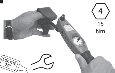
Sumontuokite naują kulno spyruoklę, užtepkite „Loctite 243“ ir užveržkite varžtus (15 Nm). Naudokite dinamometrinio rako priedą (940081).
