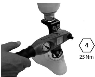
Εφαρμόστε Loctite (243) και σφίξτε (25 Nm) τους κοκκίλιες του άνω περιβλήματος. Συνδέστε και ευθυγραμμίστε τη θήκη.
