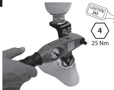
Pred nasadením vrchného krytu zrežte pylón predtým zobrazenou metódou. Naneste Loctite (243) a dotiahnite skrutky (25 Nm). Ak treba, predbežne nasadte kozmeticko-estetickú časť.
