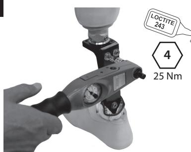
Palico odrežite s prej prikazano metodo, preden pritrdite zgornji del ohišja. Nanesite Loctite 243 in zategnite vijak (25 Nm). Znova namestite kozmetiko, če je treba.
