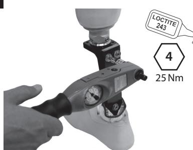
A felső tartóegység rögzítése előtt a korábban bemutatott módszerrel vága el a pilont. Használjon Loctite-ot (243), és húzza meg a csavarokat (25 nm). Ha kozmétist használ, helyezze azt vissza.a.
