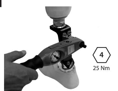
Na skrutky vrchného krytu naneste Loctite (243) a dotiahnite ich (25 Nm). Pripojte a zarovnajte lôžko.
