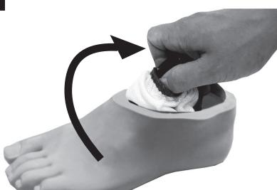
Със завъртане извадете модула пета/носещ механизъм от облицовката на протезното стъпало/чорапа за приплъзване.
