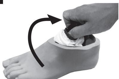
Vykrúťte nosníkovú súpravu/pätu z krytu chodidla/nasúvacieho ponožkového návleku.
