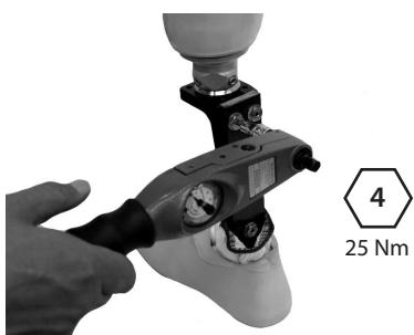
Užtepkite „Loctite 243“ ir užveržkite (25 Nm) viršutinio korpuso varžtus. Pritvirtinkite ir suliguokite bigės ėmiklį.
