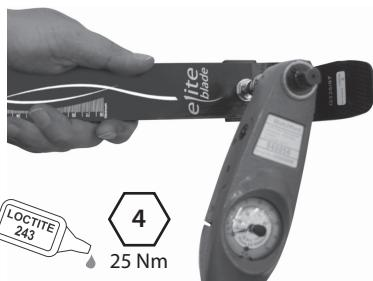
Pripojte pylón k päťovému nosníku. Naneste Loctite (243) a dotiahnite skrutku (25 Nm).
