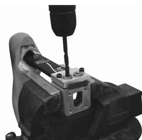
Пробийте два отвора с диаметър 8,1 мм през втулките за свредло.
