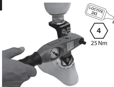
Κόψτε τον πυλώνα χρησιμοποιώντας τη μέθοδο που απεικονίζεται παραπάνω πριν συνδέσετε το επάνω μέρος του περιβλήματος. Εφαρμόστε Loctite (243) και σφίξτε τους κοχλίες (25 Nm). Εφαρμόστε ξανά την κόσμηση, κατά περίπτωση.
