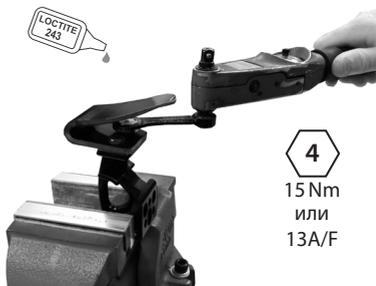
Използвайте специален шестограмен ключ 940080, адаптер за динамометричен ключ 940081 или гаечен ключ 13A/F 940273. Използвайте Loctite 243 (926012) и затегнете до 15 Nm.
