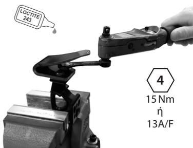
Χρησιμοποιήστε το ειδικό κλειδί Allen 940080, τον προσαρμογέα ρολόκλειδου 940081 ή το κλειδί 13A/F 940273. Χρησιμοποιήστε Loctite 243 (926012) και σφίξτε με ροπή έως 15 Nm.
