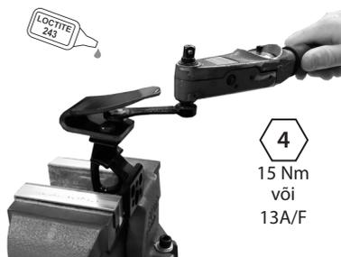
Kasutage spetsiaalset kuuskantvõtit 940080, momentvõtme adapterit 940081 või 13 A/F mutrivõtit 940273. Kasutage keermeliimi Loctite 243 (926012) ja pingutage momendiga 15 Nm.
