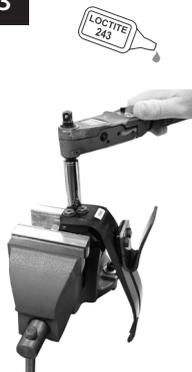
Συνδέστε το ελατήριο δακτύλων στο στήριγμα χρησιμοποιώντας Loctite 243 (926012) στους κοχλίες.
