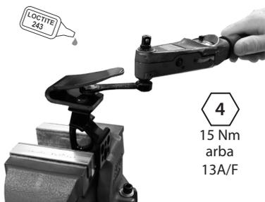
Naudokite specialų šešiabriaunį veržliaraktį 940080, dinamometrinio raktų adapterį 940081 arba 13 A/F veržliaraktį 940273. Užtepkite „Loctite 243“ (926012) ir užveržkite 15 Nm sukimo momentu.
