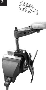
Rögzítse a lábujjrugót a tartóra, a csavarokon Loctite 243 csavarrögzítőt (926012) alkalmazva.
