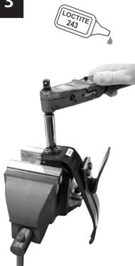
Прикрепете пружината за пръсти към носещата конструкция, като използвате Loctite 243 (926012) върху болтовете. 1. За пружини с категория от 1 до 7 използвайте шестограмен ключ 4 A/F и затегнете до 15 Nm. Не използвайте външен шестограмен ключ, тъй като той се използва при необходимост за развиване на болтовете. 2. За пружини с категории 8 и 9 използвайте гаечен ключ 13 A/F и затегнете до 25 Nm.
