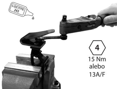
Použite špeciálny imbusový kľúč 940080, redukciu na vidlicový kľúč 940081 alebo vidlicový kľúč 13A/F 940273. Použite Loctite 243 (926012) a doťahovací moment 15 Nm.
