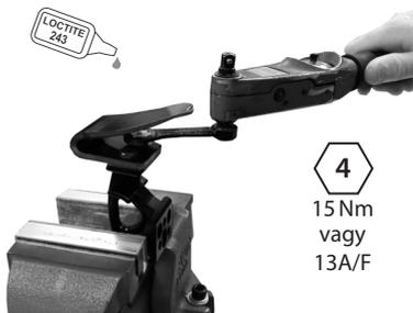
Használjon speciális 940080 imbuszkulcsot, 940081 nyomatékkulcs-adaptert vagy 940273 13A/F csavarrögzítőt. Használjon Loctite 243 csavarrögzítőt (926012), és húzza meg 15 Nm nyomatékra.
