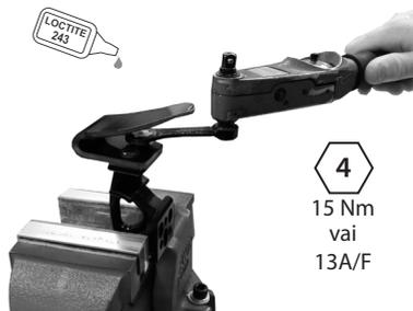
Izmantojiet īpašu seškanšu atslēgu 940080, dinamometriskās atslēgas adapteri 940081 vai 13 A/F uzgriežņu atslēgu 940273. Izmantojiet Loctite 243 (926012) un griezes momentu līdz 15 Nm.
