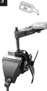
Pričvrstite oprugu palca na nosač nanošenjem ljepliva Loctite 243 (926012) na vijke.
